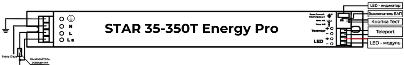
Рисунок 9 – Схема подключения БАП
