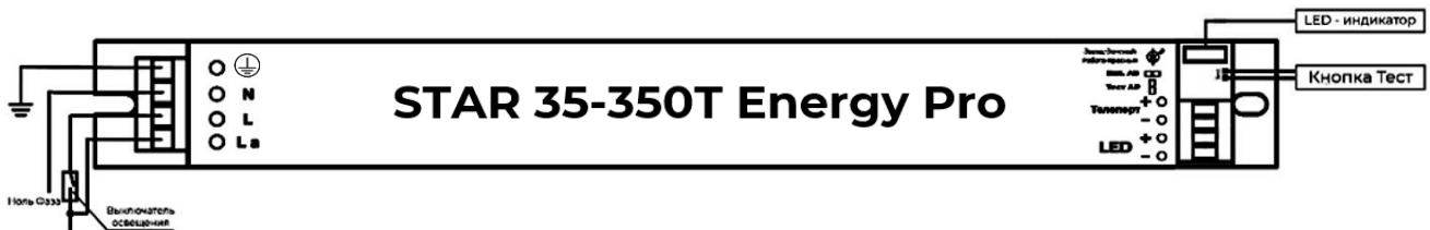
Рисунок 10 – Схема подключения кнопки «Тест»
